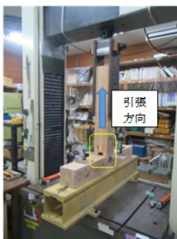
柱梁引張試験状況（負荷前） （部材は横が柱、縦が梁）
