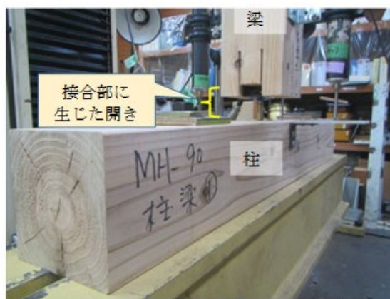
柱梁引張試験状況（負荷後）
