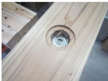
試験後のマルチボルトのめり込み状況
