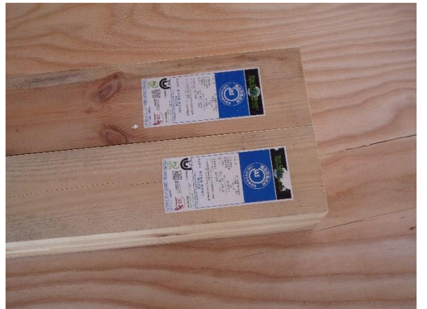
1階 オウシュウアカマツ 柱・梁 JAS 構造用集成材 マーク
