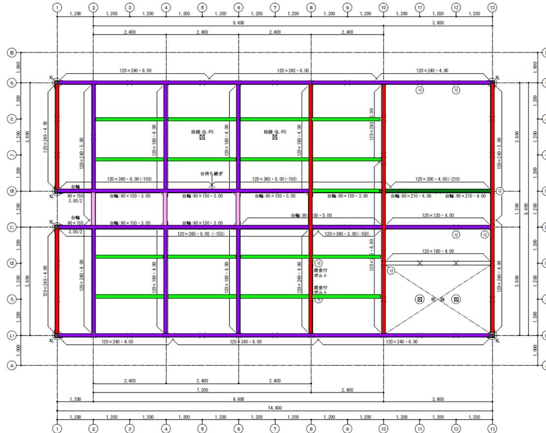
図 軸組工法等の梁伏図の例
