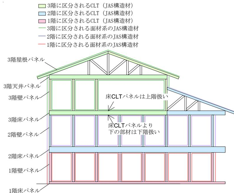
図2 CLTパネル工法の場合
