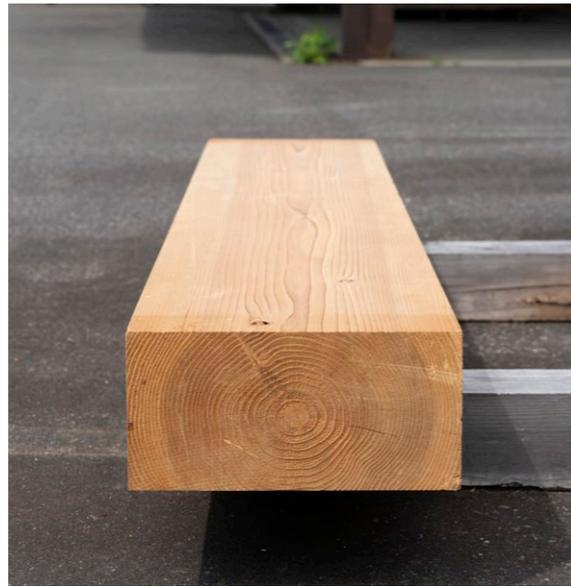
紀州杉の平角材（120×240mm）。芯持ち材で、辺材部分も含めて目が詰まっていることが分かる。高温蒸気式減圧乾燥を行っているため、内部割れや変色がなく、きれいに乾燥されている。一方、製材後数年が経過しているため、全体が艶色を帯びている。まさに経年変化による美しさだ
