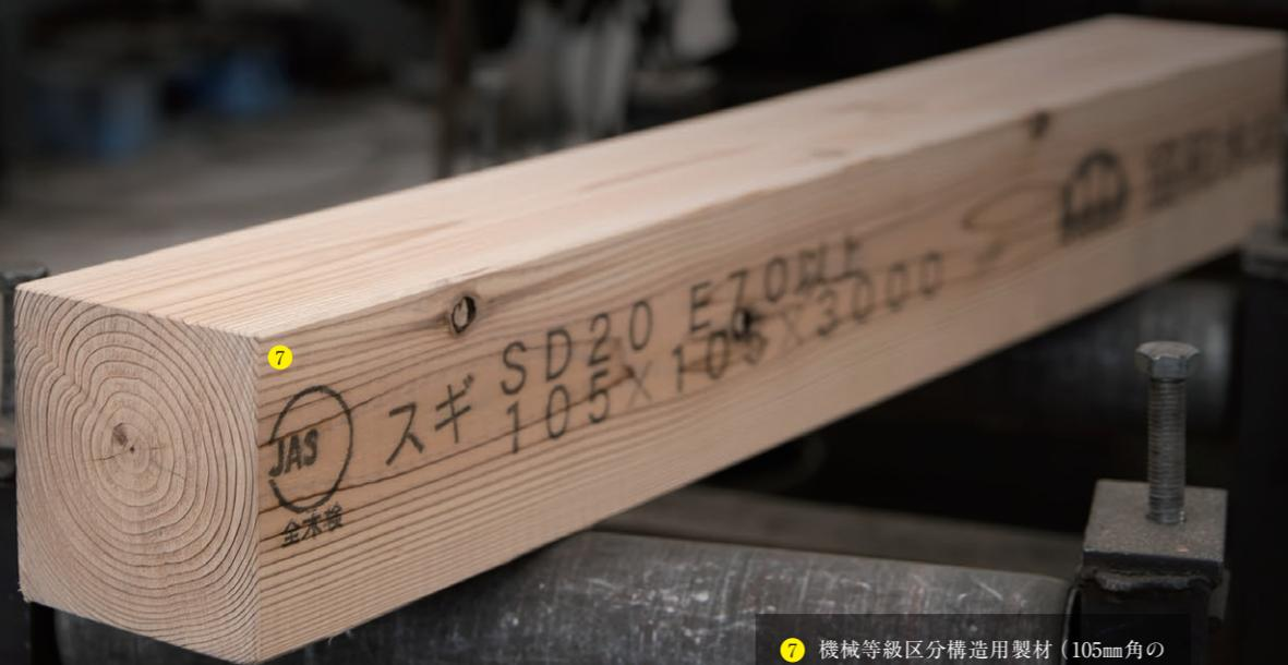
⑦ 機械等級区分構造用製材（105mm角の柱）の印字例。SD20は含水率の区分、E70以上はヤング係数の等級を示す
