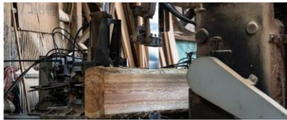
スギの丸太から平角材を製材している様子。自動送材車式帯鋸盤（シングルバンドソー）【※3】を利用して行う
