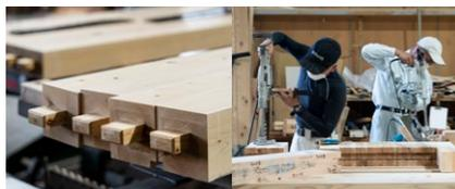
機械によるプレカット加工（ホゾ加工）された紀州松の正角材（柱）。機械加工で対応しにくい複雑な加工については、常駐大工による手加工で行う
