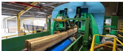
新工場YSSで、紀州杉のB材を製材している様子。ツイバンドソー【※3】を用いて加工を行う
